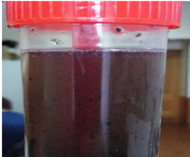
Рисунок 3. Гранулированный материал в минеральном масле
