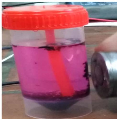
Рисунок 4. Исследование магнитной восприимчивости гранул распределенных в жидкости
